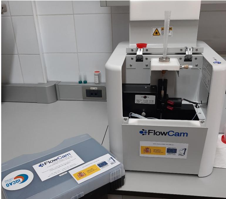
El equipo de captación de imágenes **FlowCAM 8400** (Fluid Imaging Technologies, INC.), con número de serie 10514, se ha adquirido a través del proyecto de infraestructura con referencia EQC2018-004845-P. El instrumento permite capturar imágenes de partículas, como organismos planctónicos, que se encuentran en ambientes acuáticos.
